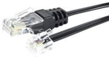
Comparación de conectores RJ11 et RJ45
